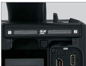
\*1: Простая релейная запись. При переключении записи с одной карты на другую звук прерывается не более, чем на 0,8 сек.
