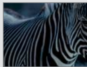
Проектор В Применив управление режимами лампы, удалось добиться того, что черные участки не размыты, однако светлые стали тусклыми и невыразительными.
